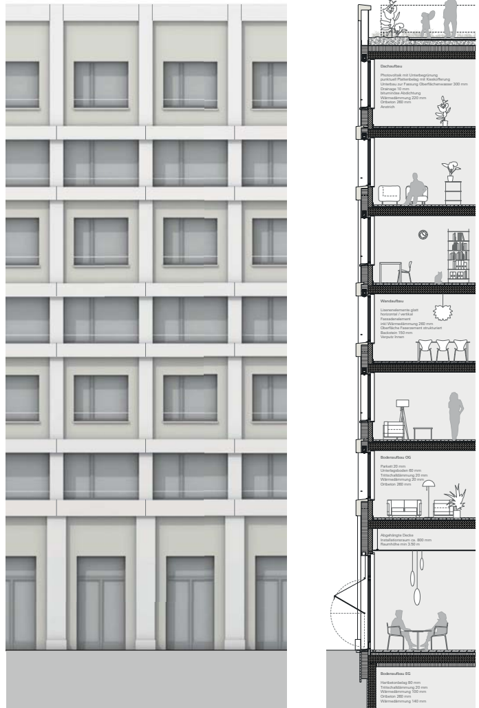
Fassadenschnitt und Ansicht
