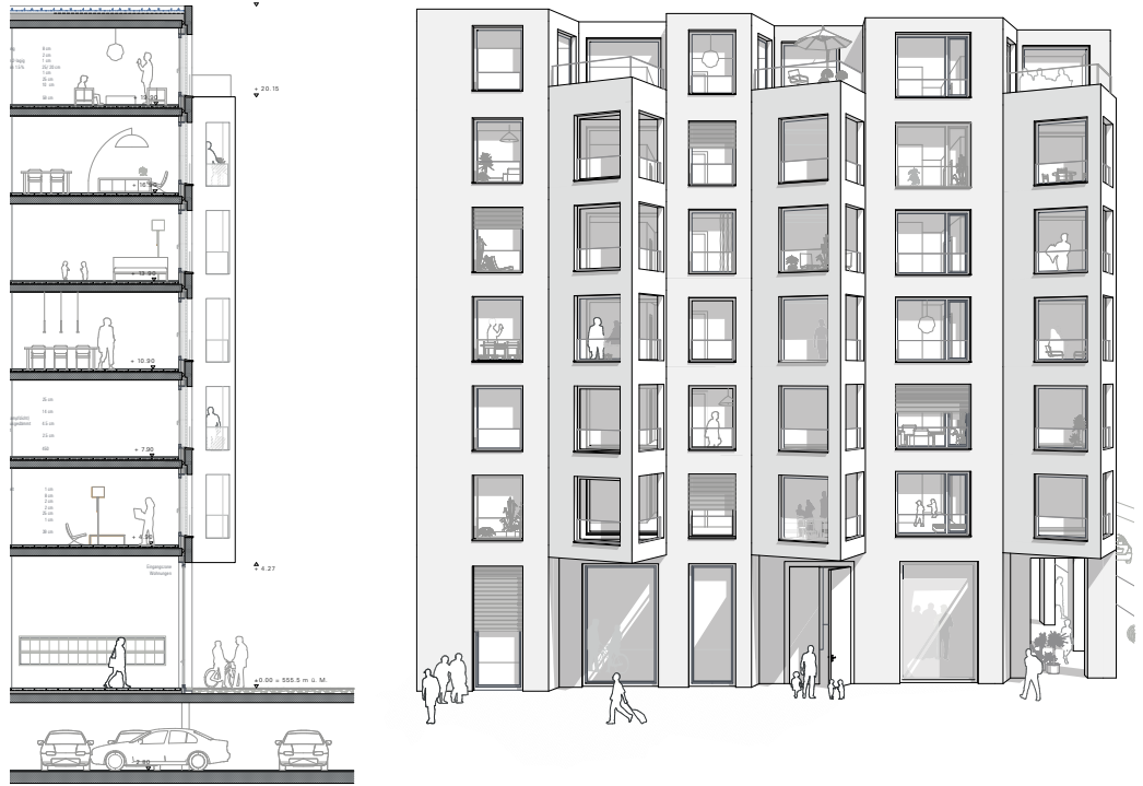
Fassadenschnitt und Ansicht
